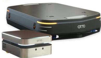
専用のレールやガイド、通路を事前登録する必要がなく、SLAM 技術によって、人やフロアのレイアウト変更など各種設備をリアルタイムで検出し荷物を搬送するための最適なルートを調整することが可能な、マテリアルハンドリングを自動化するための自律走行型搬送ロボットです。100kg 可搬の OTTO100、1500kg 可搬の OTTO1500 の二種類をご紹介します。
