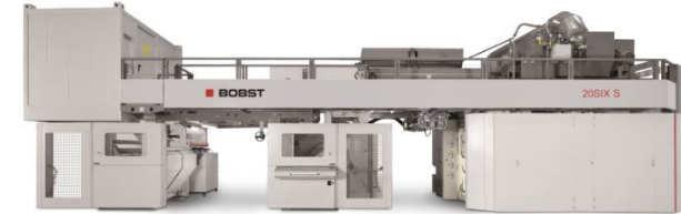
センタードラム式フレキソ印刷機(Bobst Bielefeld GmbH)
