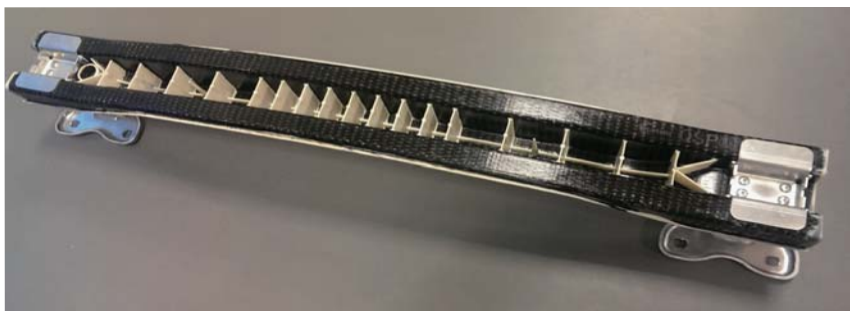
多層多厚バンパービーム (最適化によるゼロスクラップ)
