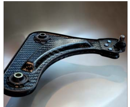
QSP®のプロセスを適用した自動車用多層サスペンションアーム
