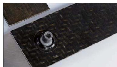
インモールドによるワンショット成形
