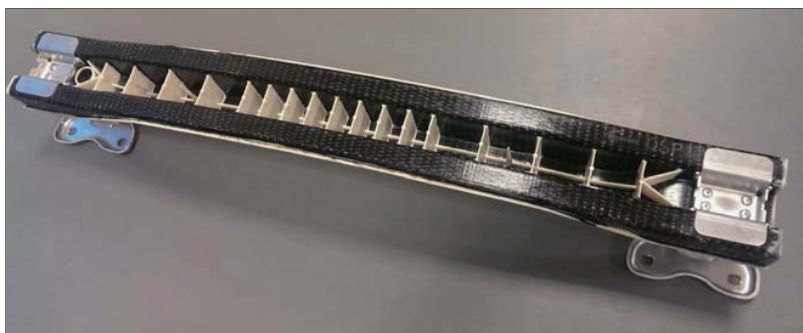
多層多厚バンパービーム (最適化によるゼロスクラップ)
