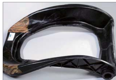
インモールドによるワンショット成形
