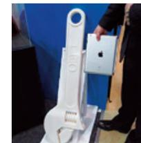
“Objet 1000”で出力したモンキレンチ。1回のみ出力で完成します。
