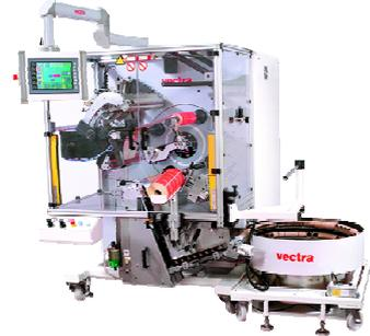
**GAVO 社製(イタリア)****紙管切断、接続装置 (実機、サンプル展示予定)**
